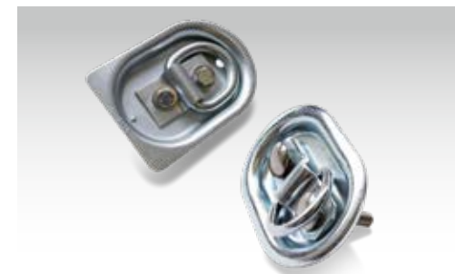
In de houten bodem verzonken sjorringen, in de houtbodem gemonteerd, trekkracht 0,2 t (4 stuks) of trekkracht 0,4 t per stuk (4 of 6 stuks)
