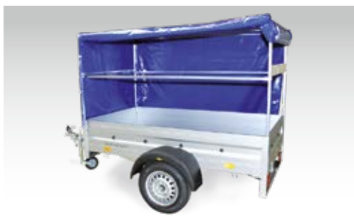
Huif en dakbogen, laadhoogte 1000/1300/1600/1800 mm (Uitvoering afhankelijk van het model)
