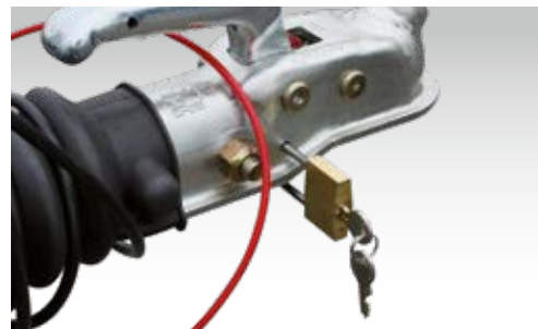
Beugel slot voor geremde aanhanger tot 3500 kg (met AL-KO AE)
