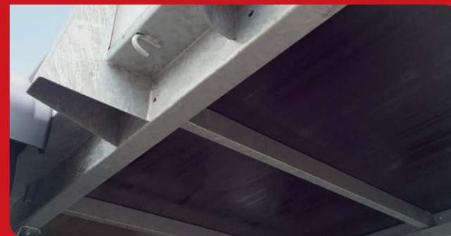
Zeer robuust, gelast chassis met kokers dwarsliggers
