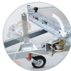
In lengte verstelbare en kantelbare lier
